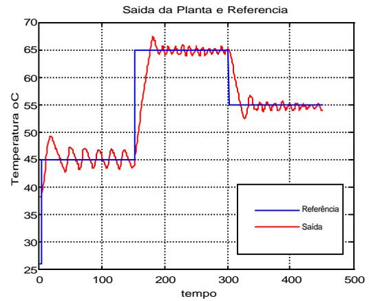
Figura 8: Saída da planta para uma referência variável.
