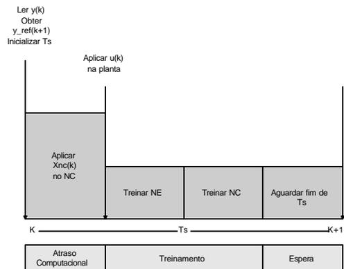
Figura 4: Diagrama temporal do treinamento do esquema de controle.
