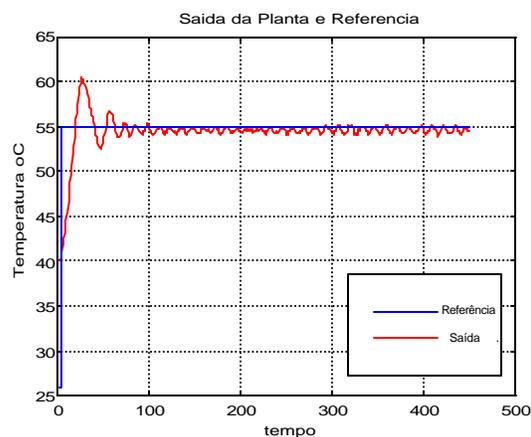
Figura 5: Saída da planta para uma referência degrau unitário.
