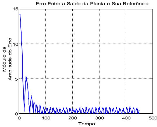
Figura 7: Módulo do erro entre a saída da rede e o sinal de referência.
