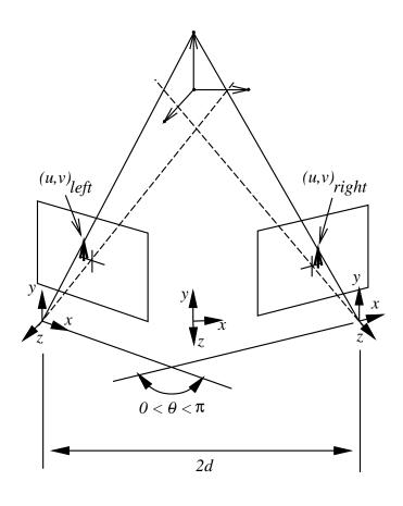
$$\begin{bmatrix} u_L \\ v_L \\ u_R \\ v_R \end{bmatrix} = \begin{bmatrix} A_{00} & A_{01} & A_{02} & A_{03} \\ A_{10} & A_{11} & A_{12} & A_{13} \\ A_{20} & A_{21} & A_{22} & A_{23} \\ A_{30} & A_{31} & A_{32} & A_{33} \end{bmatrix} \begin{bmatrix} x \\ y \\ z \\ 1 \end{bmatrix}$$
