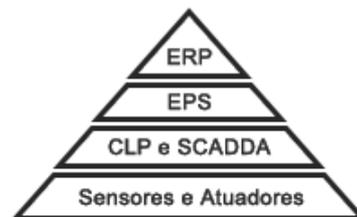
Fig. 1: Modelo em camadas de um Sistema de Automação.
